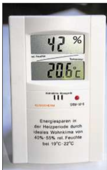
Ein Hygrometer misst die Luftfeuchtigkeit.
